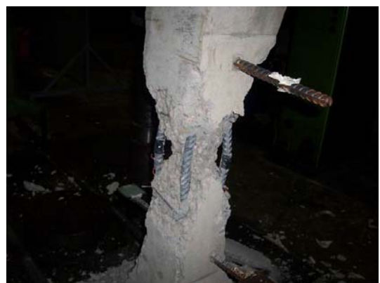
รูปที่ 9 เสาตัวอย่างหลังทำการทดสอบ
