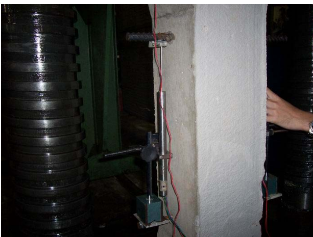
รูปที่ 3 LVDT ที่ติดตั้งแล้ว
